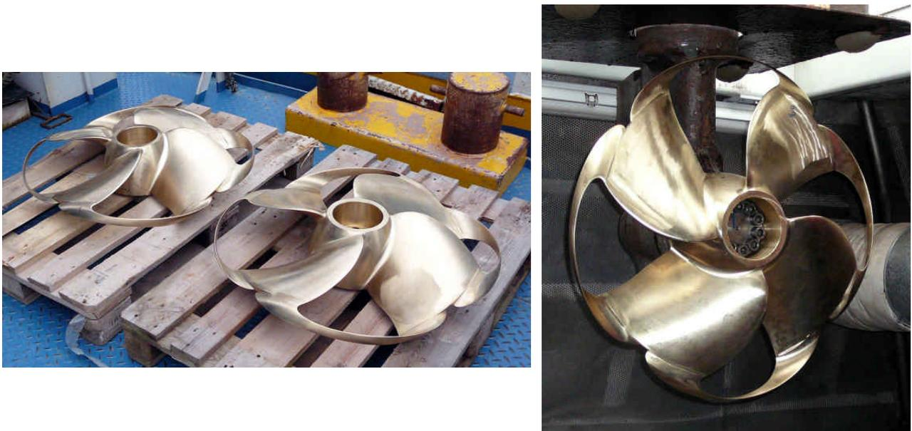
**Abbildung 94: Die neuen Bionikpropeller, angeliefert (links) und montiert (rechts)**
