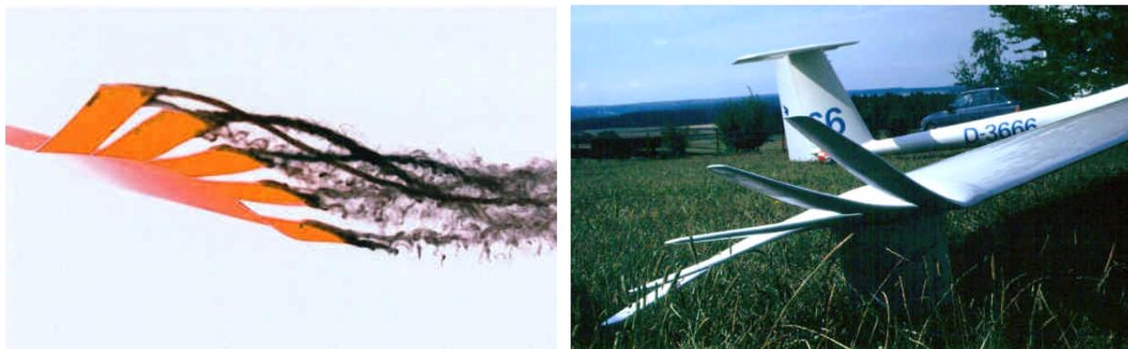
**Abbildung 12: Aufgefächerte Flügelspitze als Multi-Winglet im Windkanal (Falschfarben) und an einem Segelflugzeug (Fotos Rechenberg)**
