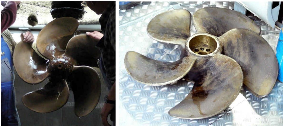
**Abbildung 92: Herausgehobener Schottelantrieb mit originalem Propeller (links),
